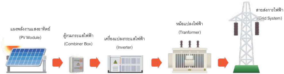
ผังกระบวนการผลิตไฟฟ้าจากพลังงานแสงอาทิตย์
